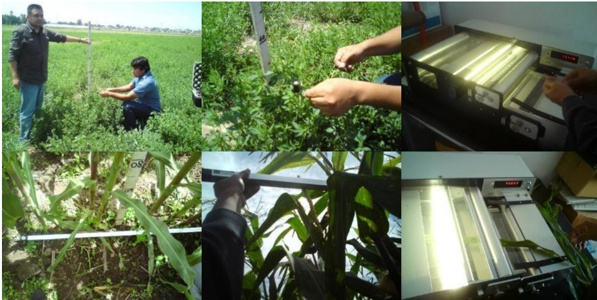
Figura 2. Medición de la RFA de alfalfa y maíz con el radiómetro Li – COR Line y medición del área foliar de la alfalfa y maíz con el integrador LI-3100 Área Meter.
