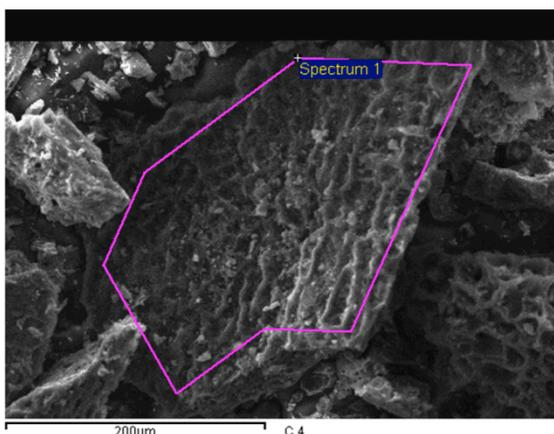
Figura 1. Imagen de microscopia electrónica de barrido de alto vacío del material carbonoso NAC-857
