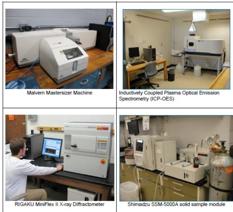
Figura 2. Aerosoles Minerales. Equipo en la caracterización elemental, mineralógica y granulométrica
