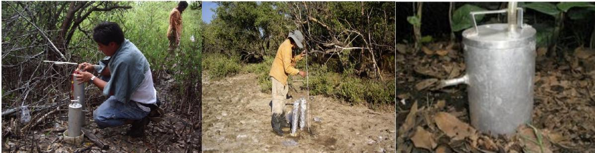
Figura 2. Sistema de monitoreo de GEI en suelos de humedales en bosques de Mangle
