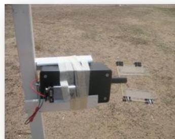
**Figura 2. Rotor instalado en la torre con dos alas, portaobjetos y cintas.**
