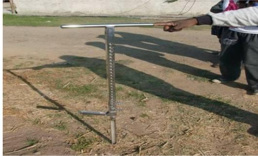
Figura 8. Barrena de muestreo de suelos con pivote.
